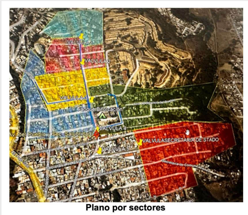
De la misma forma, se instalaron válvulas sostenedoras de presión en la comunidad de San Cristóbal Texcalucan, con el objetivo de reducir presión en la parte baja y disminuir el desperdicio del vital líquido, que representaban algunas fugas.
